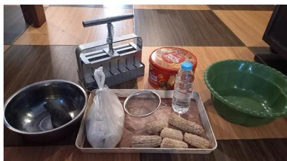
Pada pelatihan pembuatan briket bonggol jagung memerlukan alat press briket sederhana dengan isi sebanyak 21 untuk mencetak briket. Untuk tata cara menggunakan alat press briket sebagai berikut :
