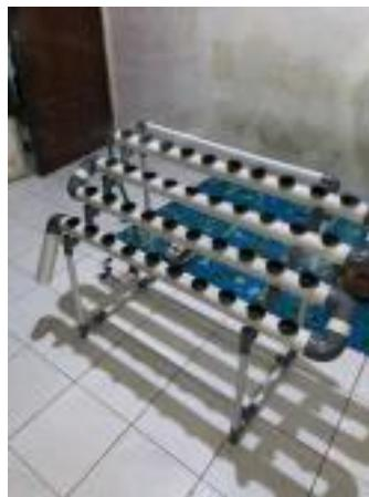
Media dibuat dari bahan baku pipa yang tidak mudah mengalami korosi dengan cara kerja hidroponik yang terus mengalirkan air. Pipa tersebut dirakit sedemikian rupa dengan bantuan lem pipa sebagai perekat agar produk kuat dan tahan lama. Bahan baku yang digunakan juga ringan dan mudah dilubangi untuk tempat penanaman sayurnya. Proses pelubangan dilakukan sesuai ukuran sayur yang akan ditanam, selain itu pipa juga mudah untuk didapatkan.
