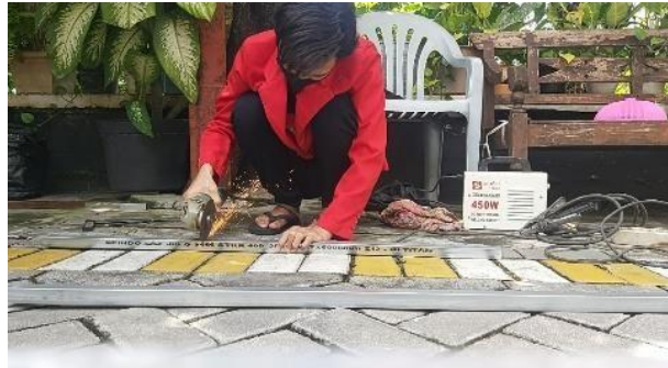
Gambar 2. Pembuatan rangkaian badan hand wash sistem injak
