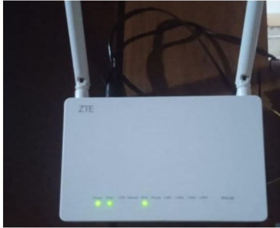
Gambar 4. Instalasi ONT di rumah pelanggan
