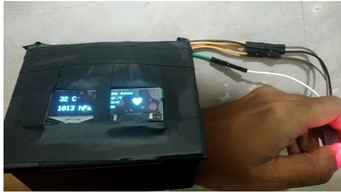
Gambar 5. Gambar alat sesudah di rangkai, alat sudah dapat menampilkan temperatur, tekanan udara, altitude, dan detak jantung.
