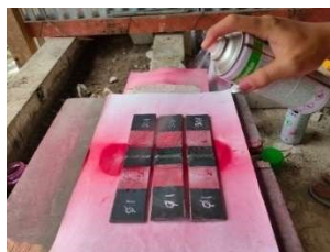
Gambar 7. Penyemprotan cairan Cleaner/Remover
