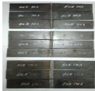
Gambar 2. Hasil Pengelasan Diameter Wire 0,8 Arus 90 A, 110 A, 130 A
