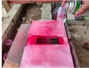
Gambar 9. Penyemprotan cairan Penetrant
