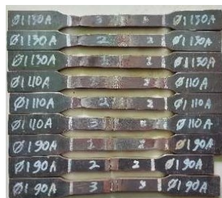
Gambar 20. Gambar Pengujian Tarik Variasi Diameter Wire Ø1 Arus 90A, 110A, 130A
