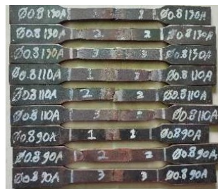
Gambar 18. Gambar Pengujian Tarik Variasi Diameter Wire Ø0,8 Arus 90A, 110A, 130A
