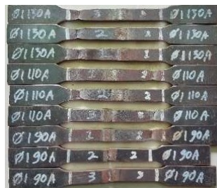
Gambar 22. Gambar Pengujian Tarik Variasi Diameter Wire Ø1,2 Arus 90A, 110A, 130A
