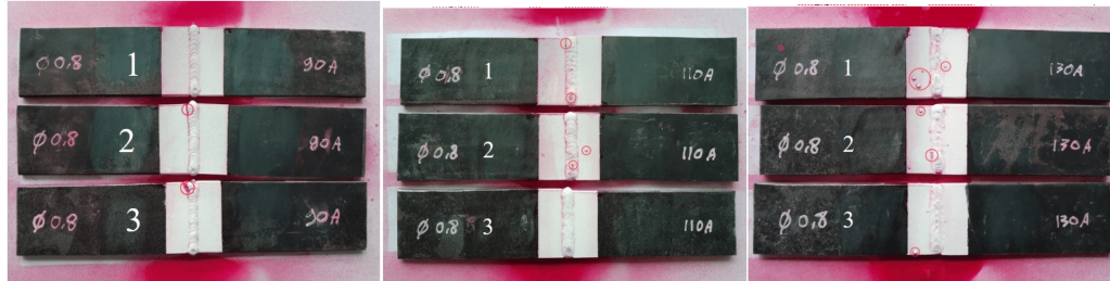
Gambar 13. Penetrasi Variasi Wire Ø0,8 Arus 90A, 110A, 130A
