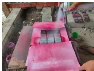
Gambar 11. Penyemprotan cairan Developer
