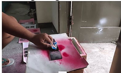
Gambar 8. Pembersihan Red Penetrant
