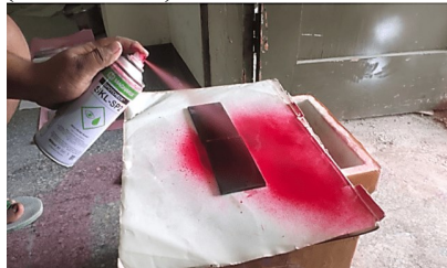
Gambar 7. Penyemprotan Red Penetrant
