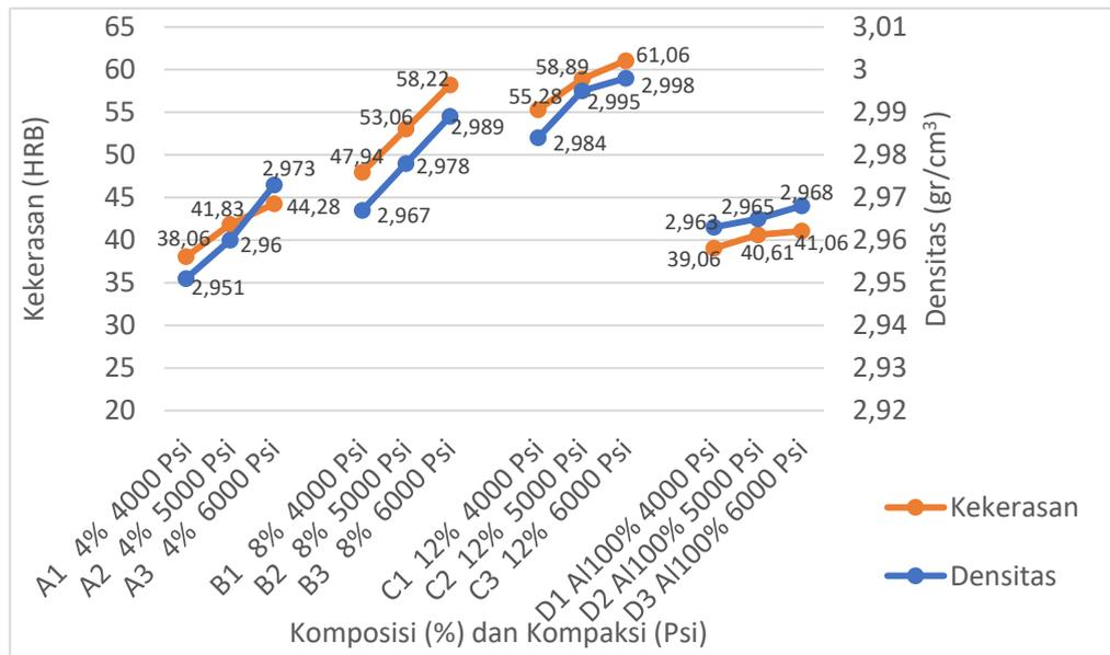
Gambar 5. Grafik hubungan densitas dengan kekerasan terhadap Al-SiC & Al Murni 100%
