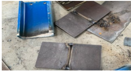
Gambar 3. Tack weld pada material
