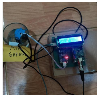
Gambar 5 Pengujian dengan air garam
