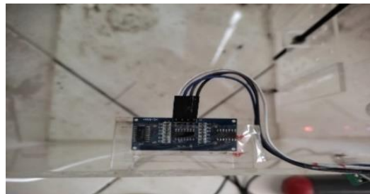
Gambar 3 Pengujian Jarak Ultrasonik Dengan Air
