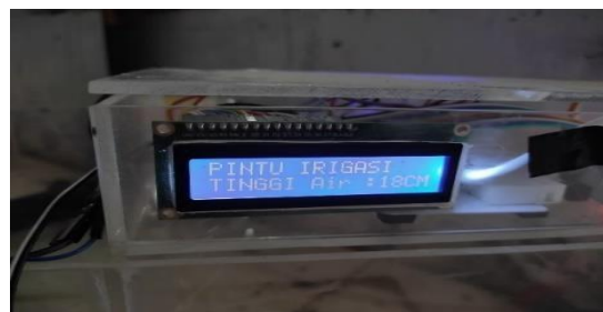
Gambar 4 Pengujian lcd 16x2 dengan dengan menampilkan data-data yang masuk dari sensor ultrasonik
