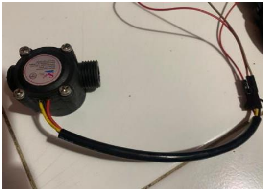
Gambar 15 Rangkaian Penyambung Kabel ke Sensor
