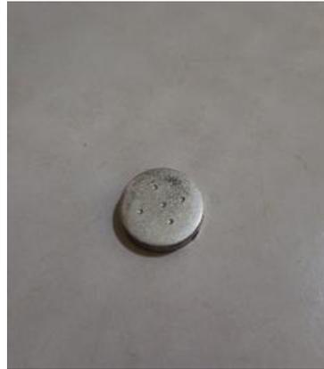
Gambar spesimen setelah uji kekerasan
