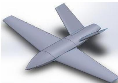
Gambar 20. Desain drone baru tampak isometri
