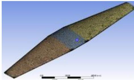
Gambar 14. Surface meshing sayap utama drone
