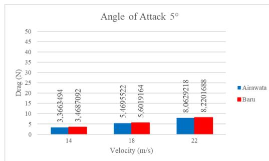
Gambar 34. Grafik perbandingan gaya hambat pada kondisi sudut serang  $5^\circ$
