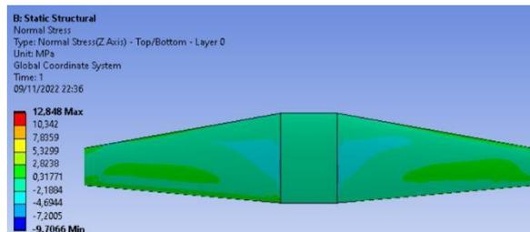
Gambar 48. Tegangan normal serat kaca pada sayap drone baru
