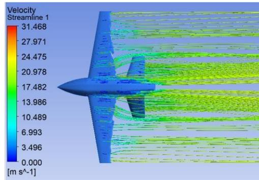
Gambar 31. Velocity Streamline 22  $m/s$  melewati drone baru 15° tampak bawah
