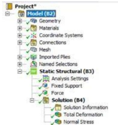
Gambar 18. Daftar *output* data analisa struktur
