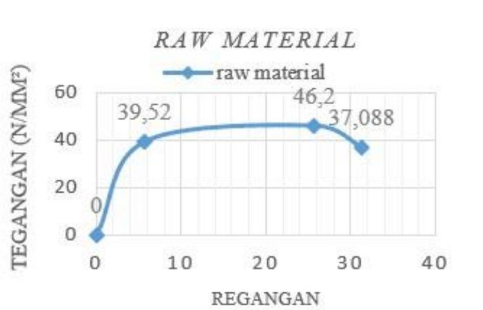
Dari hasil perhitungan diatas lalu dibuatlah grafik tegangan (N/mm<sup>2</sup>) dan regangan untuk mengetahui bahwa hasil perhitungan uji tarik pada raw material baja ST 42 mempunyai tegangan maksimum sebesar 46 kg/mm<sup>2</sup> dan regangan teknik maksimum sebesar 25,68 %.
