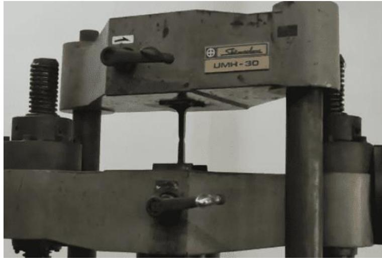
Gambar 7. Pengujian tarik (tensile test)
