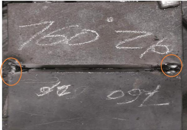
Gambar 5 Pembuatan Track Weld
