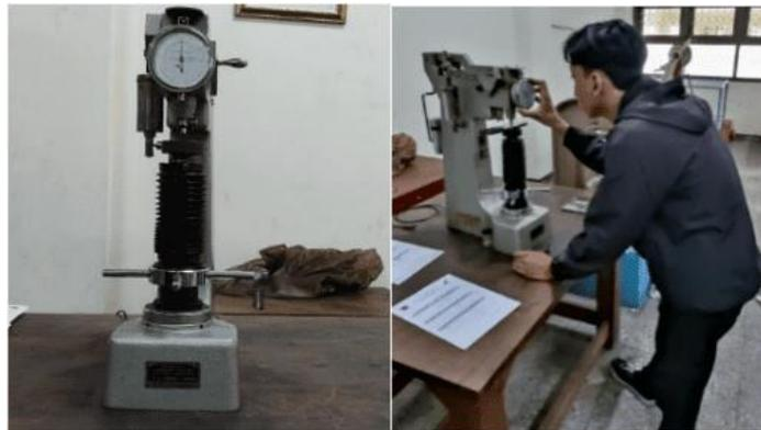
Gambar 8. Proses uji kekerasan dengan metode rockwell
