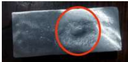
Gambar 24. Cacat Penyusutan Dalam (650°C)
