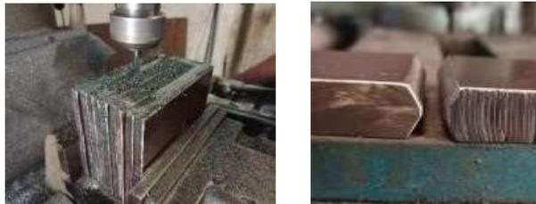
Gambar 3 Proses pembuatan alur double-V groove
