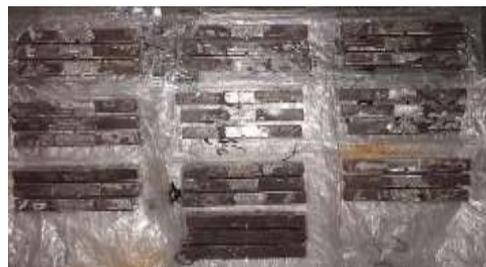
Gambar 7 Pembuatan spesimen uji impak (JIS-Z 2202)
