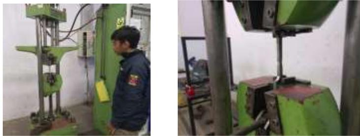
Gambar 8 Proses pengujian tarik
