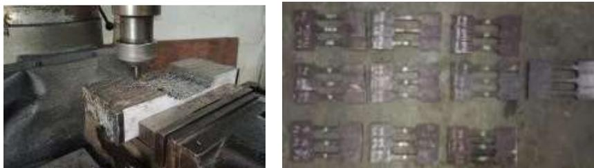
Gambar 6 Pembuatan spesimen uji tarik (JIS-Z 2201)
