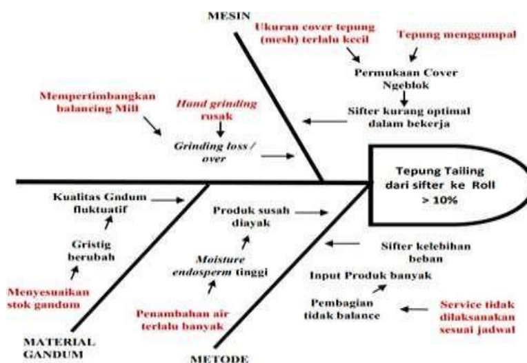
Gambar 3. Analisis Permasalahan Dengan Menggunakan Diagram Fishbone Faktor-faktor yang mempengaruhi kinerja sifter antara lain sebagai berikut :
