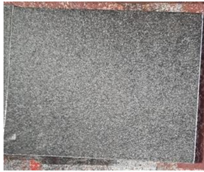
Gambar 7. Hasil proses sandblasting dengan tekanan 5 bar dan waktu 8 detik.
