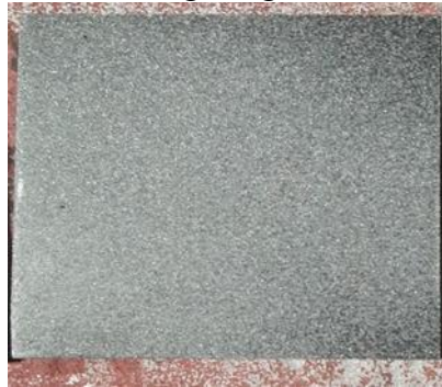
Gambar 8. Hasil proses sandblasting dengan tekanan 5 bar dan waktu 12 detik.
