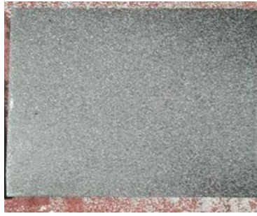
Gambar 5. Hasil proses sandblasting dengan tekanan 4 bar dan waktu 12 detik.
