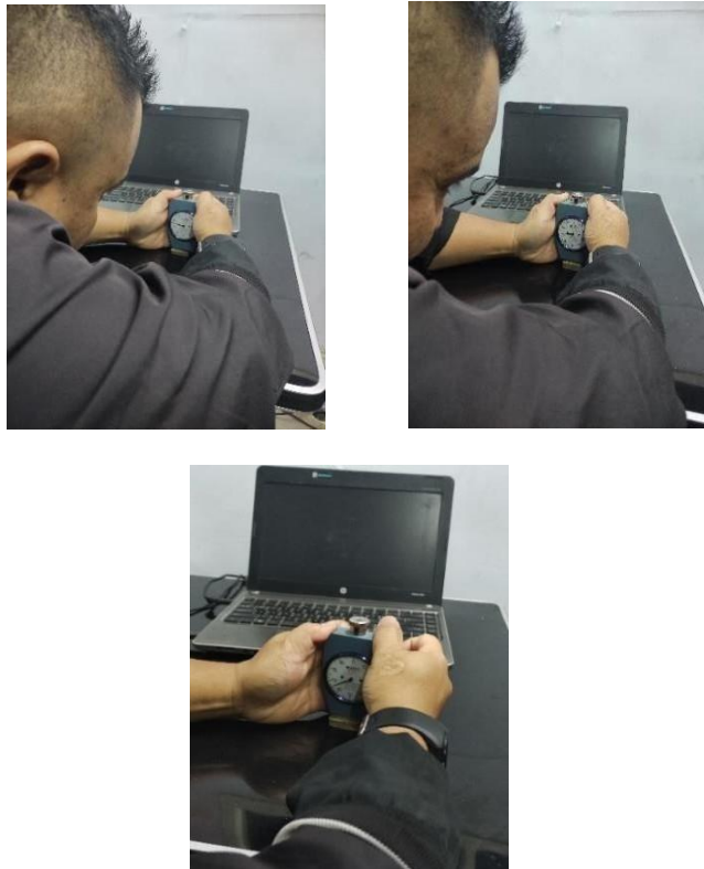
Gambar 7. Proses uji kekerasan Shore D
