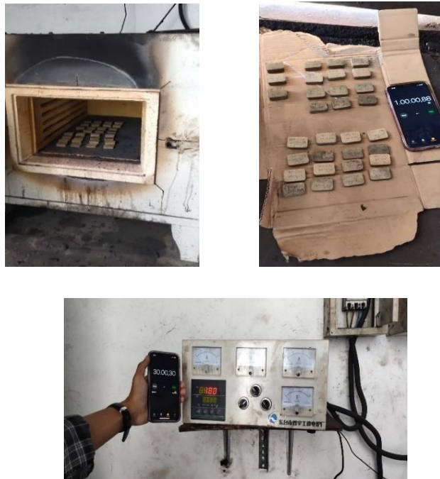
Gambar 6. Proses pemanasan dengan oven
