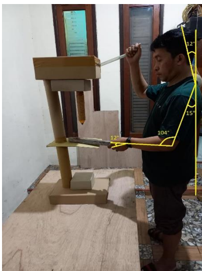
Gambar 17 Postur Kerja Operator Mesin Bor
