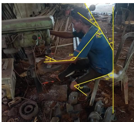
Gambar 10 Postur Kerja Operator Mesin Bor
