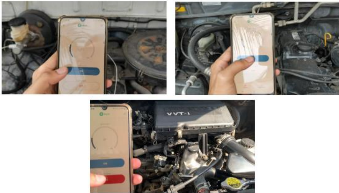
Gambar 7. Contoh pengaplikasian starter berbasis IoT pada berbagai kendaraan. Proses starter kendaraan juga dipengaruhi oleh kondisi mesin sebagai contoh jika pemasangan dilakukan di kendaraan konvensional terutama mesin diesel akan mengalami susah starter di awal dikarenakan tidak menggunakan sistem injeksi yang dimana perlu proses penyalaan glow plug lebih dahulu baru kendaraan bisa start dengan baik seperti kendaraan injeksi lainnya.
