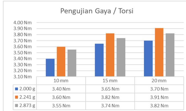
Gambar 19 Hasil pengujian torsi turbin angin dengan kecepatan 2.0 m/s
