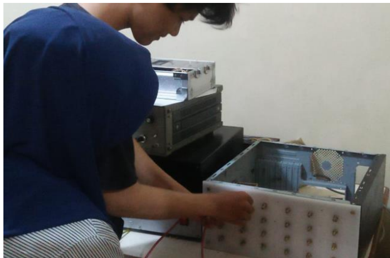
Gambar 3. Pelatihan Desain dan Penggunaan Alat Kalibrator Mikro Ohm menggunakan Busbar
